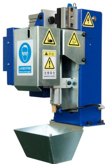
Рисунок 4. Внешний вид станции автоматической очистки сварочной горелки
