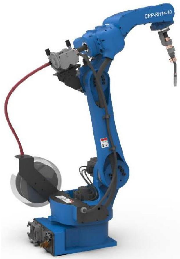
Роботы серии CRP-RH – это шестиосевые промышленные роботы с полый рукой, разработанные компанией CRP. Зона досягаемости данного манипулятора составляет 1 440 мм, а грузоподъемность – 10 кг.
