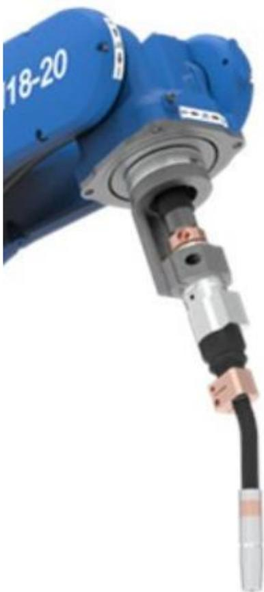
Система защиты от столкновений разработана специально для сварочных роботов последнего поколения с центральной 6-ти осевой системой управления и создаёт высокую степень безопасности и манёвренности для горелок с газовым и жидкостным охлаждением.
