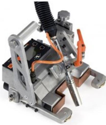
**Малая механизация** – это наиболее эффективный способ повышения производительности сварки на предприятиях по сборке металлоконструкций. Она также положительно сказывается на безопасности и эргономике сварочных работ. Поскольку трудоёмкие операции выполняет сварочный трактор, сварщик может сосредоточить своё внимание на контроле технологического процесса и качества.
