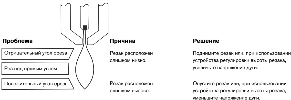
Рисунок 4 – Углы среза
